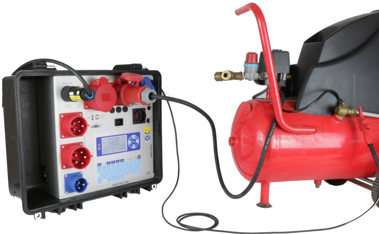
Stecker des Prüflings an passende Prüfdose anschließen. Mit der Sonde die geerdeten Metallteile des Prüflings abtasten.
