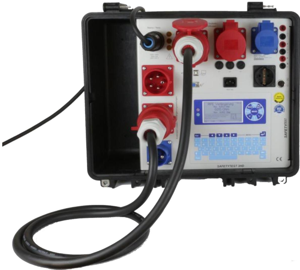
Für die Messung von CEE 16/32, Stecker und Buchse in das Prüfgerät, Prüfdose und Prüfstecker einstecken und den Verlängerungsleitungstest durchführen.
