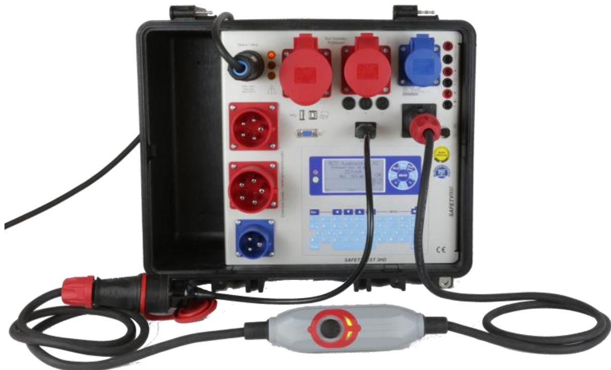
Bei der RCD/PRCD/PRCD-S/PRCD-K Prüfung wird der Schukostecker in die Prüfdose des Prüfgerätes gesteckt. Die andere Seite der RCD-Leitung wird in den Einbaustecker „RCD Test“ ggf. mit einem Adapter, wie im Bild zu sehen, gesteckt.
