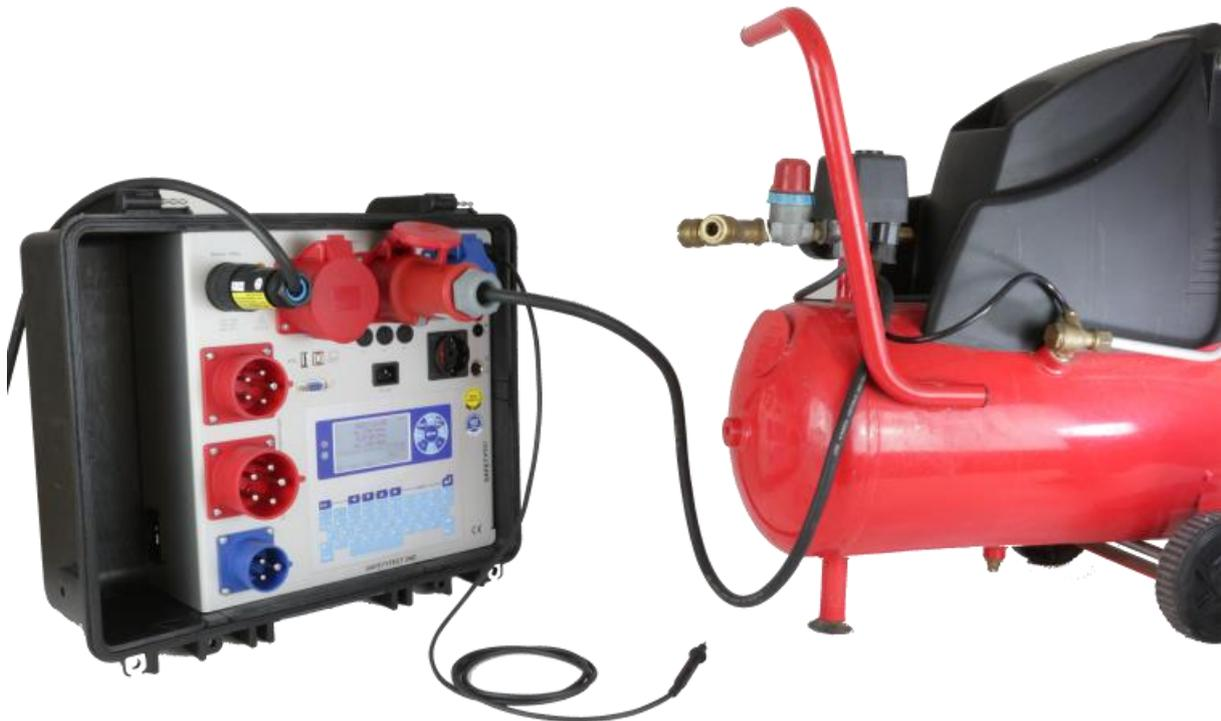
Prüfablauf: „Mit Iso-Messung“ > Ja. Stecker des Prüflings an Prüfdose des Messgerätes anschließen. Den Prüfling einschalten.
